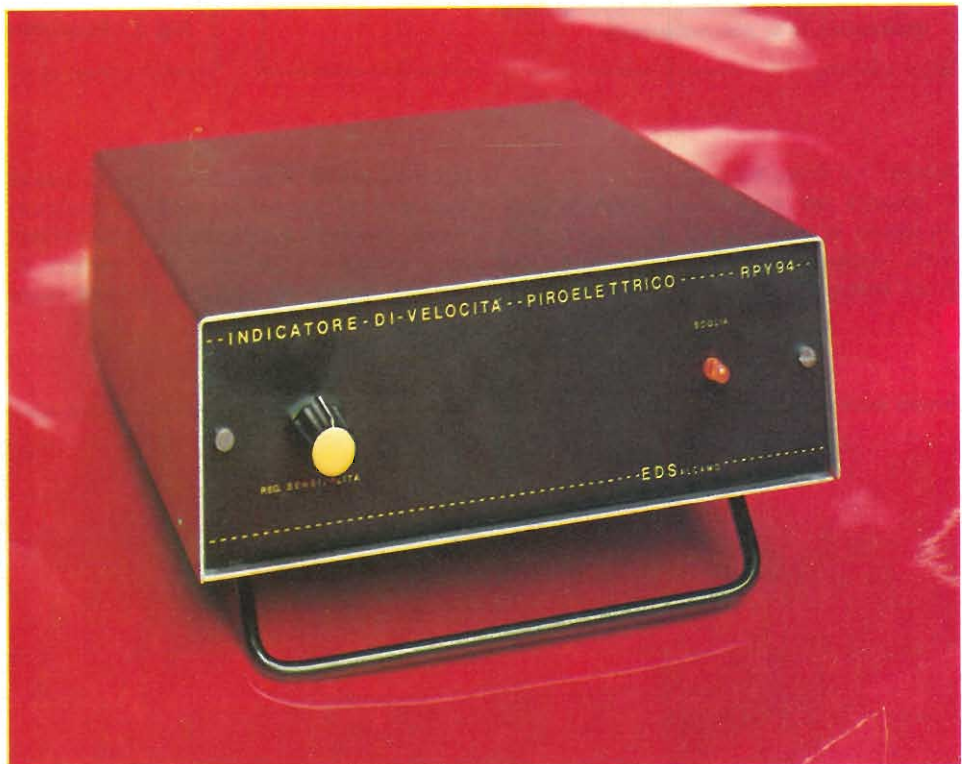
Aspetto esterno dell'apparecchio, si noti il regolatore di sensibilità e l'indicatore di soglia a LED.
