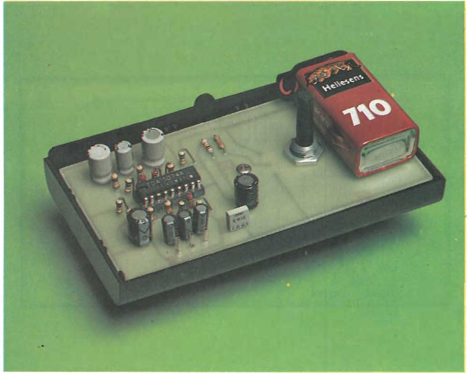
Vista interna dell'HI-FI Car Fader a realizzazione ultimata.
